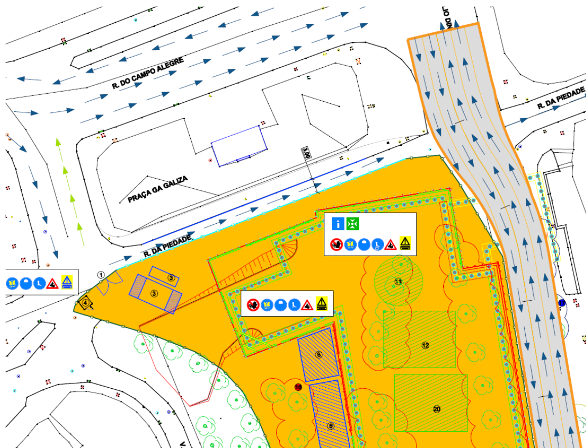
Figura 1: Extrato da Planta - Plano de Estaleiro da Galiza – fase 2 a.
